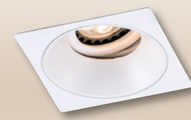
GN 7533H ( 9800 ) 長82mm 寬82mm 高105mm 附OSRAM 3030 6珠 8w 3000K/4000K/5700K 鋁材粉體烤漆
