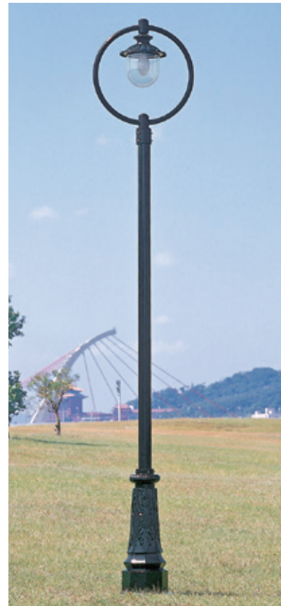
GN 75447 (200000) 寬600mm 高3350mm E27x1 LED 另計 鋁合金+鍍鋅鋼管焊接組裝成型 PC燈罩、鍍鋅基礎座 管徑Ø76mm (整組)
