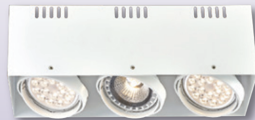
GN 75383 ( 60000 ) 長461mm 寬161mm 高161mm 附OSRAM LED 18珠 22wx2 附COB LED 18wx1 3000K/4000K/5700K、鋼鐵材加工成型 粉體烤漆
