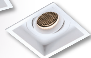
GN 75334 ( 13300 ) 長111mm 寬111mm 高125mm 附COB LED 15w 3000K/4000K/5700K 鋁材粉體烤漆、(細邊框) 防眩光蜂巢網
