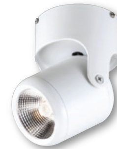
GN 75391 ( 15000 ) 寬75mm 高125mm 附COB LED 5wx1、3000K 鋁材烤漆、可調角度
