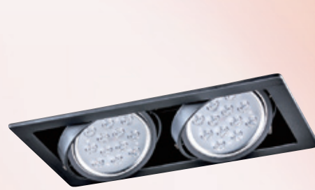
GN 75405 ( 16500 ) 長345mm 寬195mm 高80mm 附歐司朗晶片 12珠 15wx2 3000K/4000K/6000K 金屬烤漆、另有白框
