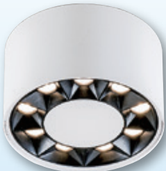
GN 75398 ( 15000 ) 寬100mm 高58mm 附LED 18wx1、CRI>90 3000K/4000K、鋁材粉體烤漆 PC罩、(另有黑色)
