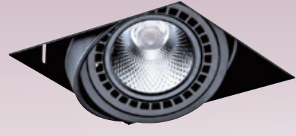
GN 7541A ( 10500 ) 長160mm 寬160mm 高90mm 附歐司朗晶片 COB 15wx1 3000K/4000K/6000K 金屬烤漆、無邊框請準確開孔
