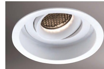
GN 75335 ( 15000 ) 寬111mm 高125mm 附COB LED 18w模組 3000K/4000K/5700K 鋁材粉體烤漆、(細邊框) 防眩光蜂巢網
