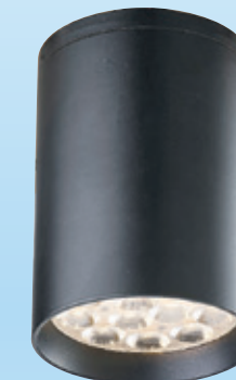
GN 7539B ( 12000 ) 寬80mm 高110mm 附OSRAM LED 12珠 15w 3000K/4000K/5700K、鋁材加工成型 粉體烤漆、6063航空鋁材、(另有白色) 吸頂式
