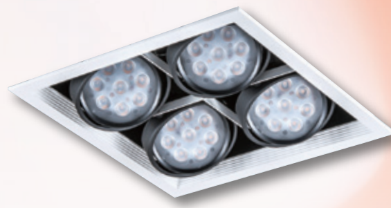
GN 7540F ( 37000 ) 長245mm 寬245mm 高90mm 附歐司朗晶片 8珠 12wx4 3000K/4000K/6000K 鋁框、另有黑框
