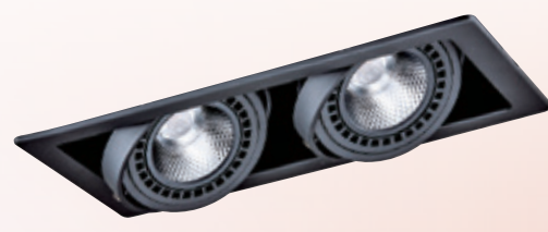
GN 75402 ( 19000 ) 長345mm 寬195mm 高80mm 附歐司朗晶片 COB 15wx2 3000K/4000K/6000K 金屬烤漆、另有白框
