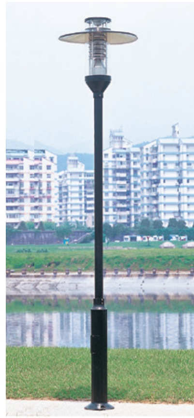
GN 75443 (275000) 寬700mm 高3400mm E27x1 LED 另計 鋁合金、PC燈罩、鍍鋅鋼管 鍍鋅基礎座、管徑Ø76mm (整組)
