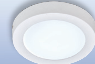
GN 75428 ( 5500 ) 寬170mm 高32mm 附LED 12w 110v-220v、3000K/6500K 鋁製品烤白、吸頂式
