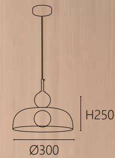
OK 21871/2 30000 Ø300 H250mm 線長1500mm 內含LED 5W 3000K 鋼材 玻璃
