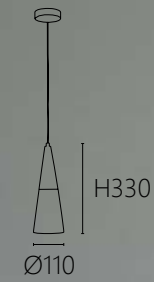
OK 20801 25000 Ø110 H330mm 線長1500mm 內附LED 5W x 1 3000K 鋼材 清光玻璃
