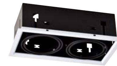
JBR 20255 尺寸 : L327 W176 H100mm 開孔 : L310 W160mm
