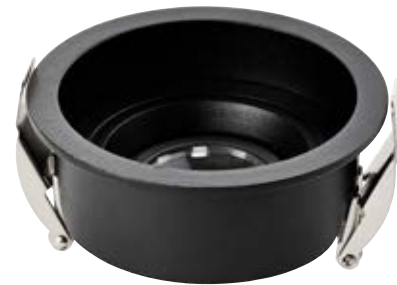
JBR 20802 材質：鋁材 尺寸：Ø82 H42 mm 嵌孔：Ø80 mm (可適用 MR16)
