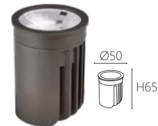
M65 可訂製 CRI 97 光源：PHILIPS 尺寸：Ø50 H65mm 功率：8W 通光量：848 Lm 光色：3000K /4000K /6000K 材質：壓鑄鋁 發光角度：24°/36° 演色性：CRI>90
