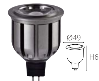
MR16 光源：PHILIPS 尺寸：Ø49 H61mm 功率：6W 通光量：636 Lm 光色：3000K / 4000K / 6000K 材質：鋁材 發光角度：25° 演色性：CRI>90 可選槍灰 / 白殼
