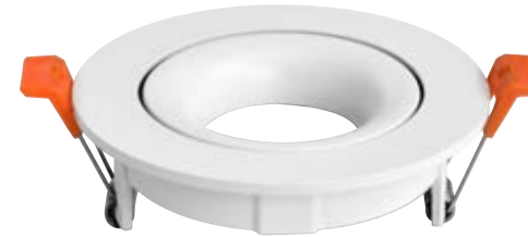
JBR 20813 材質：鋁材 尺寸：Ø105 H50 mm 嵌孔：Ø95 mm (可適用 MR16)
