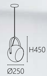
OK 21811 50000 Ø250 H450mm 線長1500mm E27 x 1另計 鋼材電鍍
