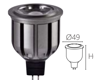
MR16 光源：PHILIPS 尺寸：Ø49 H61mm 功率：6W 通光量：636 Lm 光色：3000K /4000K /6000K 材質：鋁材 發光角度：25° 演色性：CRI>90 可選槍灰 / 白殼
