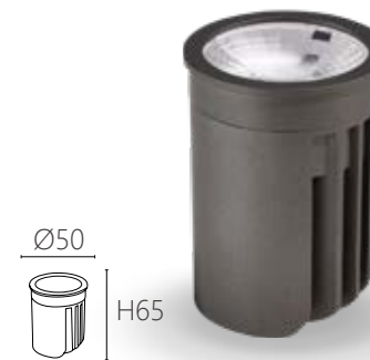
M65 可訂製 CRI 97 光源 : PHILIPS 尺寸 : Ø50 H65mm 功率 : 8W 通光量 : 848 Lm 光色 : 3000K / 4000K / 6000K 材質 : 壓鑄鋁 發光角度 : 24°/36° 演色性 : CRI > 90
