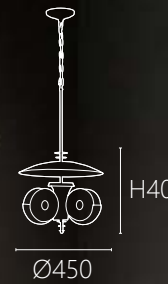
OK 21531 96000 Ø450 H400mm 鏈長600mm G9 x 3 另計 鋼材電鍍 玻璃
