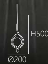
OK 21791 23800 Ø200 H500mm 線長1000mm G9 x 1另計 鋼材烤漆 玻璃
