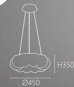
OK 21591 30000 Ø450 H350mm 線長1500mm 內含LED 36W x 2 三段式光色 鋼材 滾塑
