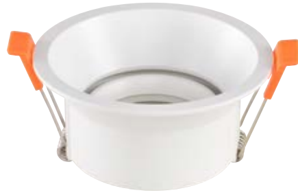
JBR 20821 S 材質：鋁材 尺寸：Ø80 H42 mm 嵌入孔：Ø75 mm (可適用 MR16)
