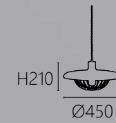
OK 21851 36000 Ø450 H210mm 線長1000mm E27 x 1 另計 鋼材烤漆
