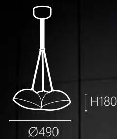
OK 20931 126000 Ø490 H180mm 線長1500mm 內附LED 15W x 3 3000K 鋼材 玻璃
