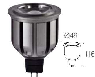
MR16 光源：PHILIPS 尺寸：Ø49 H61mm 功率：6W 通光量：630 Lm 光色：3000K /4000K /6000K 材質：鋁材 發光角度：25° 演色性：CRI>90 可選槍灰 / 白殼
