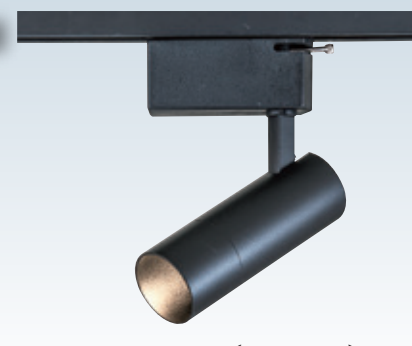
GN 7516J ( 8800 ) 長140mm 寬50mm 高200mm 附COB LED 12w 3000K/4000K/5700K、鋁材粉體烤漆 防眩光、光源內縮、(黑、白)
