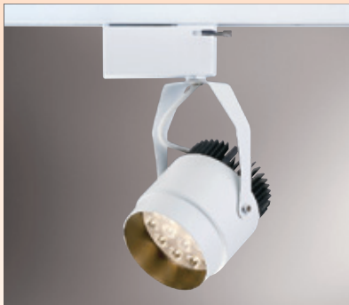
GN 75195 (12500) 長130mm 寬95mm 高260mm 附OSRAM LEDx18珠 22w 3000K/4000K/5700K、1070冷鍛壓散熱器 鋁材加工成型粉體烤漆、防眩光、另有黑
