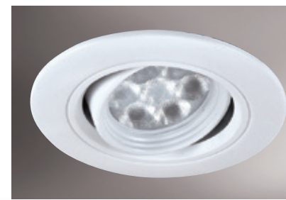
GN 75299 ( 11200 ) 寬108mm 高65mm 附歐司朗晶片LED 10w、全電壓 黃光/白光/自然光 防潮PC框白色、鱗片式散熱 可調照射角度、 台灣製造
