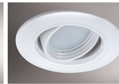
GN 7529B ( 11200 ) 寬108mm 高65mm 附歐司朗晶片LED 10w、全電壓 黃光/白光/自然光 防潮PC框白色、鱗片式散熱 可調照射角度、 台灣製造
