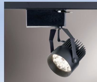
GN 75178 ( 7500 ) 長90mm 寬75mm 高180mm 附OSRAM LED 12珠 3000K/4000K/5700K、鋁材加工成型粉體烤漆 1070冷鍛壓散熱器、防眩光、(黑、白)
