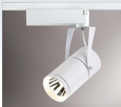
GN 75167 ( 17500 ) 長150mm 寬78mm 高240mm 附CREE COB LED 30w 3000K/4000K、鋁材加工成型 粉體烤漆、6063鋁材實心棒料、另有黑
