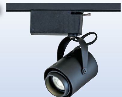
GN 75173 ( 8500 ) 長100mm 寬70mm 高180mm 附OSRAM LED 3030 6wx4珠 3000K/4000K/5700K 鋁、鐵材加工成型粉體烤漆(黑、白)
