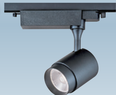
GN 75164 ( 21300 ) 長68mm 寬55mm 高120mm 附COB LED 15w 3000K/4000K/5700K 鋁材粉體烤漆、(黑、白)
