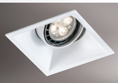
GN 75287 ( 6500 ) 長90mm 寬90mm 高80mm 附MR16 LED 6w 3000K/4000K/5700K、鋁材加工成型 粉體烤漆
