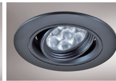
GN 7529A ( 12000 ) 寬108mm 高65mm 附歐司朗晶片LED 10w、全電壓 黃光/白光/自然光 防潮PC框黑色、鱗片式散熱 可調照射角度、 台灣製造
