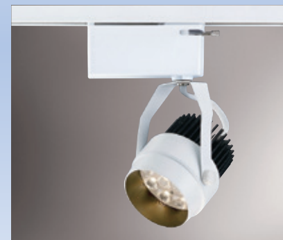
GN 75177 ( 8000 ) 長95mm 寬65mm 高190mm 附OSRAM LED 3030x12珠 15w模組 3000K/4000K/5700K、1070冷鍛壓散熱器 鋁材加工成型粉體烤漆
