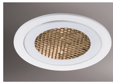
GN 7528A ( 8800 ) 寬88mm 高105mm 附OSRAM LED 3030x6珠 8w 3000K/4000K/5700K、鋁材粉體烤漆 防眩光蜂巢網
