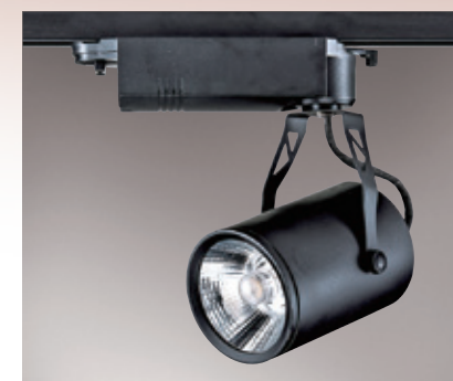
GN 7521B ( 23300 ) 寬78mm 高175mm 附COB LED 35w、美國科銳晶片 110v-220v、3000K/6500K 帶風扇、另有白座
