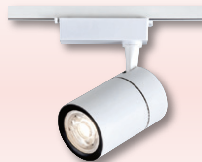
GN 7520H ( 5800 ) 寬90mm 高210mm 附COB LED 15w 110v-220v、3000K/6500K 另有黑座
