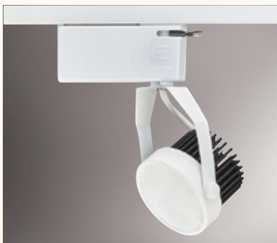
GN 75199 (8000) 長90mm 寬80mm 高170mm 附OSRAM LED 3030x12珠 3000K/4000K/5700K、鋁材加工成型 粉體烤漆、擴散板、1070冷鍛壓散熱器 散光型
