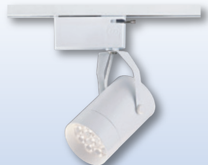
GN 75174 ( 8800 ) 長120mm 寬75mm 高200mm 附OSRAM LED 3030x12珠 3000K/4000K/5700K、鋁材加工成型粉體烤漆 1070冷鍛壓散熱器、防眩光、(黑、白)
