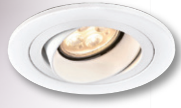
GN 75284 ( 6500 ) 寬94mm 高70mm 附OSRAM LED 4珠 6w 3000K/4000K/5700K、鋁材加工成型 粉體烤漆
