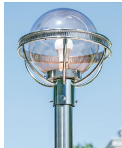
GN 75469 ( 71300 ) 寬330mm 高350mm E27x1 LED 另計 不鏽鋼焊接組裝成型、10"PMMA燈罩 管徑Ø60mm 管柱 另計
