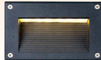
GN 75648 ( 14500 ) 寬162mm 高96mm 深65mm 附LED 3w 暖白、全電壓 鋁合金壓鑄成型、砂黑 ABS塑料預埋盒、預埋盒： 寬155mm 高95mm 深70mm
