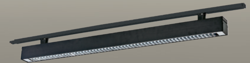
GN 74914 ( 36800 ) 長1250mm 寬70mm 高135mm 附T8 LED燈管 4尺 20wx1 鋁合金烤平光黑、鋁格柵 軌道式、軌道
