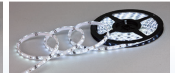
GN J27 ( 5650 ) (1米) 5050燈帶、1米60珠 1米約15W(防水膠套) 5公分一個裁接點、1捲5米
